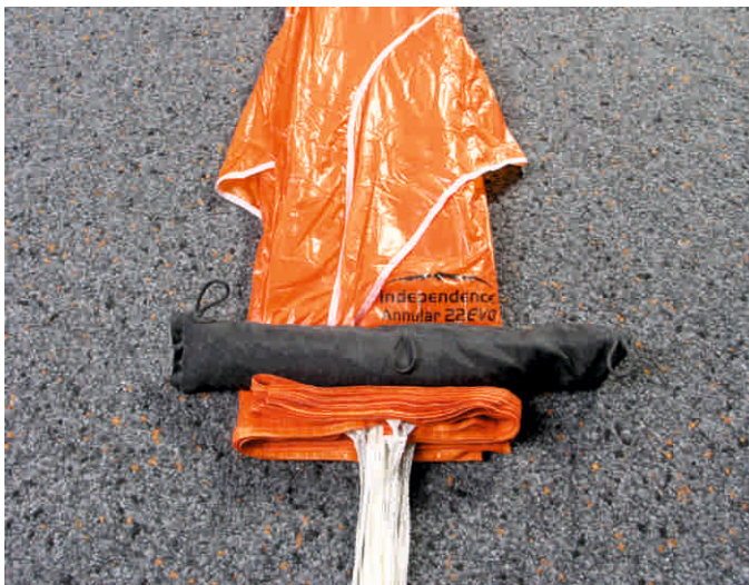
1. Basis S-förmig auf Containerbreite einschlagen (ggf. die RAMAir Pockets seitlich etwas herausziehen).
